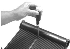
**2.** Utiliser un ciseau de ¼ po. Placer le côté plat du ciseau près de la tête, découper le tube endommagé, aussi près de la tête que possible. Un trou rond sera créé dans la tête du capteur.
