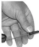
**3.** Vaporiser le manchon de caoutchouc à l'aide de lubrifiant et le glisser sur une clé hexagonale de 5/64 po.
