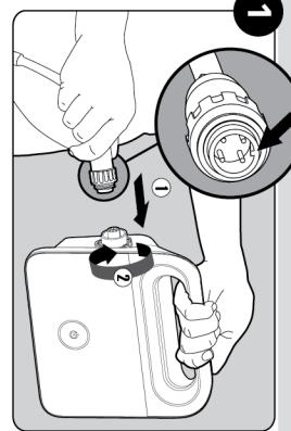
Conecte el cable flotante a la fuente de alimentación.
