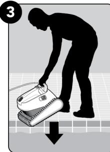
Coloque el limpiador en la piscina. Suelte el limpiador de piscina y deje que se sumerja en el fondo de la piscina. Asegúrese de que el cable flotante no está obstruido.
