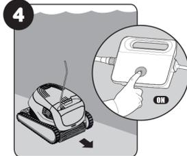
Allumez l'alimentation. Le nettoyeur se met à fonctionner jusqu'à ce qu'il complète le cycle de nettoyage.
