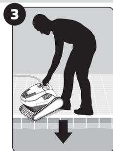
3 Coloque el limpiador en la piscina. Suelte el limpiador de piscina y deje que se sumerja en el fondo de la piscina. Asegúrese de que el cable flotante no está obstruido.
